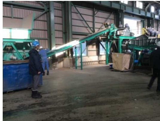
図表 32 破碎後ホッパーへ投入
