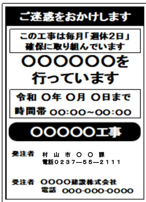
（図）工事標示板への明示の例
