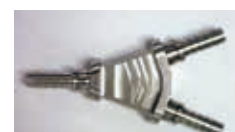
F1：小型ジェット機部品（6・4チタン材）
