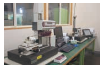
形状測定器（手前）と粗さ測定器
