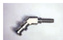
F1：小型ジェット機部品（6・4チタン材）
