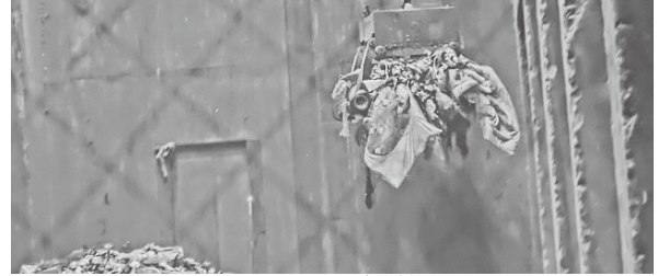
燃えるごみの かくはん 攪拌作業
