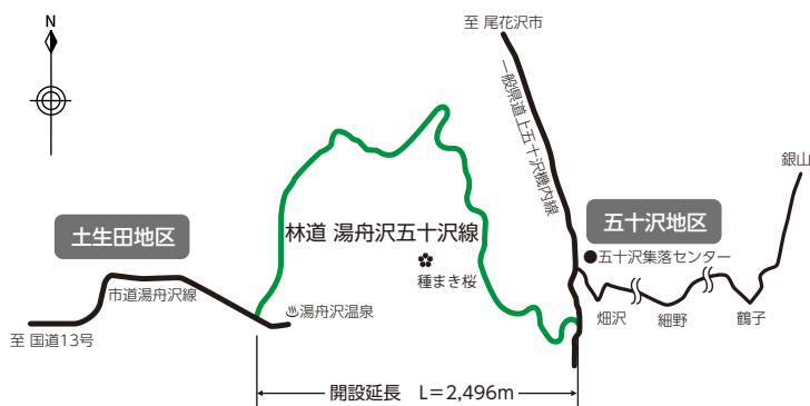
■林道湯舟沢五十沢線：延長2,496m、全幅員4.0m（車道幅員3.0m）
